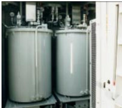
Обеспечение смазкой с помощью контейнерного насоса
